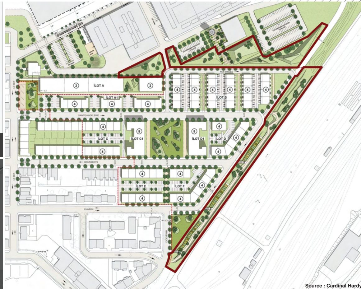
Le projet résidentiel démontrant les murs écrans composés de sols très contaminés en rouge
