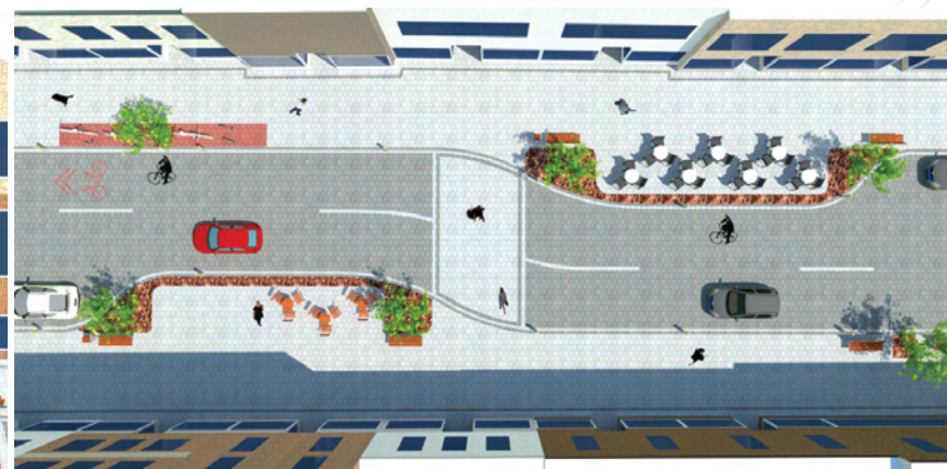
Aménagement de saillies végétalisées recouvertes par un prolongement de la marquise. L'ensemble agit en tant qu'avertissement à la présence de la traverse piétonne et à la déviation du parcours.
