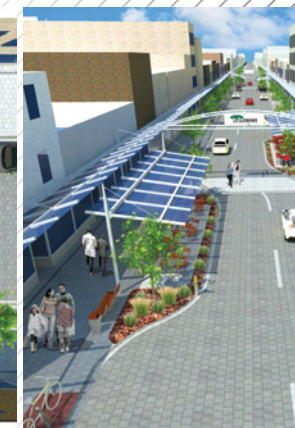
Aménagement de saillies végétalisées recouvertes par un prolongement de la marquise. L'ensemble agit en tant qu'avertissement à la présence de la traverse piétonne et à la déviation du parcours.
